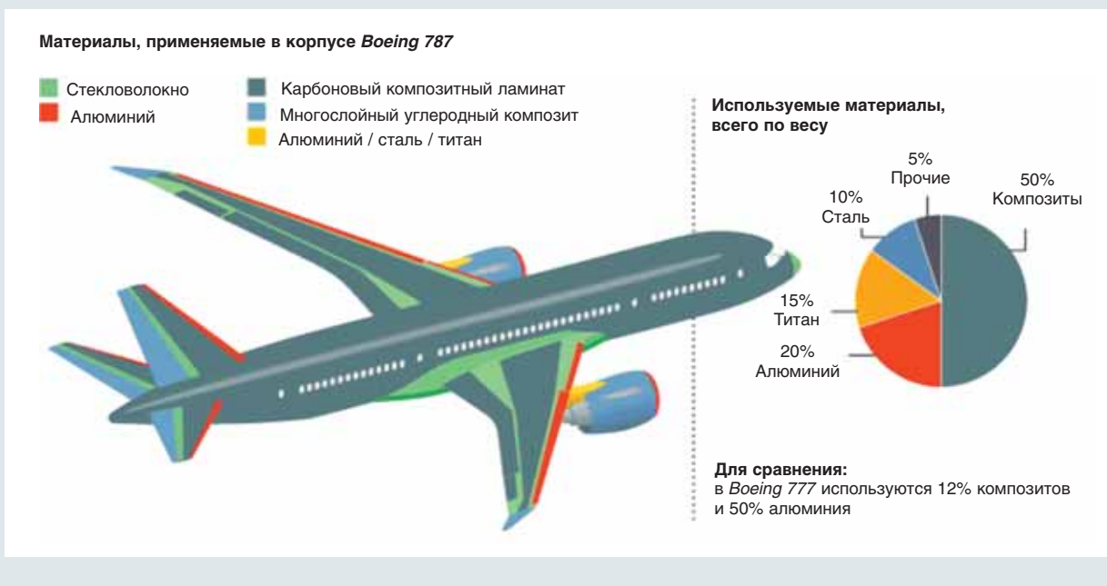
Диаграмма применяемых конструкционных материалов в Boeing 787
